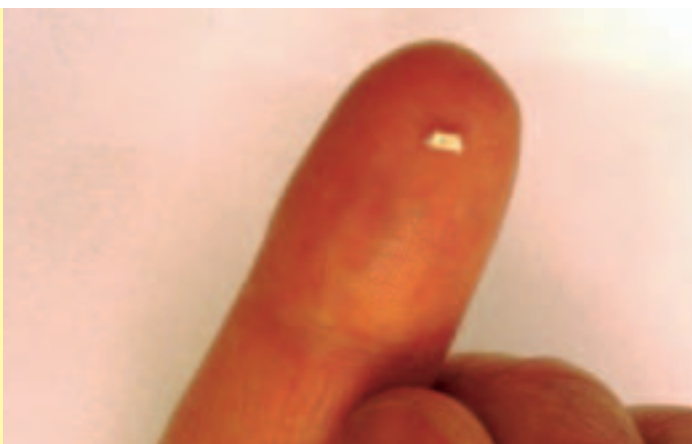
En la imagen se observa un pointLed, cuyo diámetro es de 2 mm y su peso de 6 miligramos. In this picture, a pointLed can be observed, whose diameter is 2 millimeters and whose weight is 6 milligrams.
